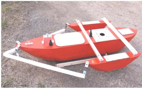
図-3 著者らが作成したトリマラン型橋上操作艇<sup>15)</sup>
