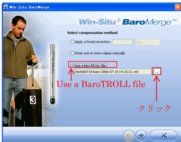
大気圧補正に用いる大気圧計データを選択（チェック）し、「OK」ボタンをクリックします。
