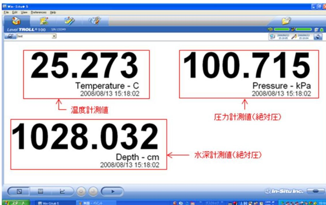
画面右上にコンピュータの時刻と、Level TROLL の時刻が表示されます。このとき、Level TROLL の時刻がコンピュータの時刻と 2 秒以上ずれている場合は、Level TROLL の時刻が赤色で表示されます。
