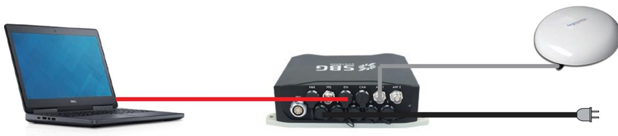
また、Navsightは、任意のポートよりGNSS受信機が測位した座標のNMEA GGAセンテンスを出力することもできます。これにより、船上プロセッサにプライマリGNSSアンテナを接続するだけで、機器設定を変更することなく、GNSS精度確認に必要なデータを手軽に収録することもできます。
