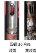
銅製のノズルコートと導電率センサーガードが海洋生物の付着を防ぎます
