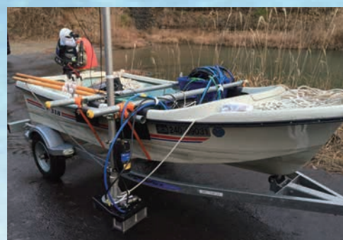
ダム湖でのFRP船へのT20機装例
