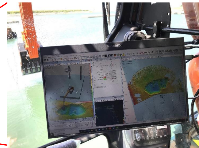
重機内に配置されたパネルPCに映されるPDSインタフェースの例
