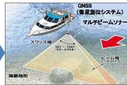
マルチビームによる出来形測量
