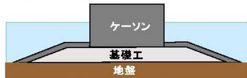
基礎工の位置(防波堤)
