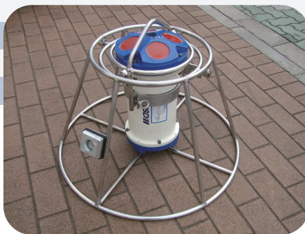
ワークホースADCP海底設置架台 ロック板を外す事によりジナル式設置架台としても使用可能
