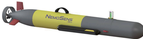
450kHz サイドスキャンソナー + オプションペイロード搭載例
