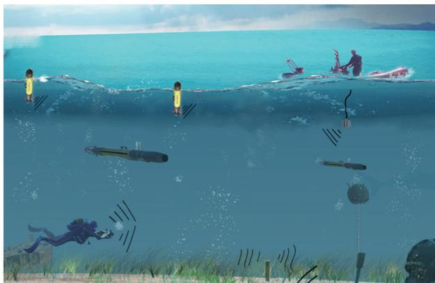
COMET 300は、リアルタイム測位と音響通信システムを備えた費用対効果の高い自律型無人潜水機(AUV)であり、海洋研究と産業の現在のニーズを満たすように設計されています。最大10ノットのパワフルさと、スワム機能を有しており、複数台のCOMETを同時に展開し、限られた時間で広い水中エリアをカバーすることができます。COMET 300は、海洋エネルギー分野または保護地域の監視、海洋資源の検出、または地雷除去などの広範な地域調査に理想的なソリューションです。
