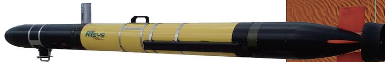
450kHz/900kHz サイドスキャンソナー + 測深器搭載例
