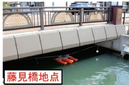
図-3 藤見橋地点でのADCPによる観測風景
