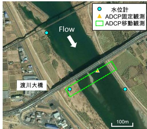
図-1 四万十川渡川大橋付近の平面図と観測体制
