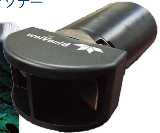
Teledyne BlueView 社製 3D スキャニングソナーは、水中の構造物や地形の 3 次元計測が行える画期的な測量機器です。ソナーヘッドを ROV や三脚などに固定し、周囲 360°（最大 30m）の 3 次元ポイントクラウド（点群）データを取得することができます。点群データはソフトウェアにて任意に回転させながら多方向から検証することができるため、防災管理において重要なダムや防波堤の亀裂や、構造物の破損などの細かな変化を発見することができます。また、MotionScan 機能をアップグレードすることにより、小型船舶の舷側に艦装した動的環境下でスキャニングや、一般的なナローマルチビームソナーのような移動計測も可能になります。
